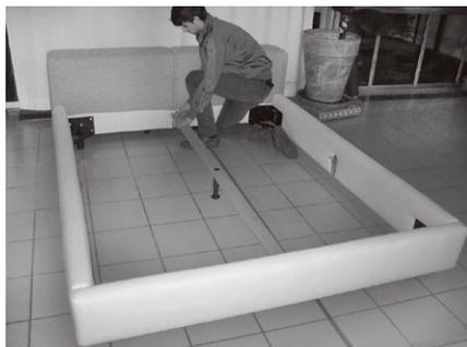
3. Verschrauben Sie nun die Seitenteile erst mit dem Kopfteil, dann mit dem Fußteil. Anschließend hängen Sie die Mittelzarge auf gewünschter Höhe in die Aufnahme an Kopf- und Fußteil ein. Der höhenverstellbare Stützfuß muss individuell durch Drehen des Innenteils auf die Höhe angepasst werden. Wollen Sie die Matratze tiefer einlegen, hängen Sie alle Lattenrostwinkel niedriger und richten Sie die Höhe des Mittelfußes am Fußboden aus. Die Einlegetiefe variiert um etwa 7 cm.
