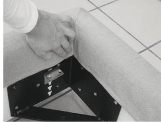
1. Legen Sie den Bezug für den Korpus um das Bett herum aus. Suchen Sie die zwei Eckpartien mit der Verbindungsnaht und fangen Sie an einer Ecke an die Naht des Bezuges genau auf Gehrung aufzulegen.
