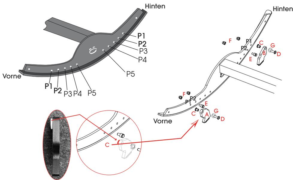
1. Schrauben Sie je einen Stellfuß (A/B) mit einer Rundkopfschraube (D) und einer Federscheibe (G) handfest von innen (an den 4 Positionen P1) in die Kufe ein (beachten Sie hierbei "vorne" und "hinten").
