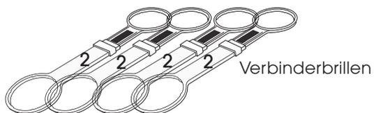
2. Heben Sie das Element leicht an, schieben Sie die Verbinderbrillen (2) von unten auf die Kunststoffgleiter (1) und drücken Sie diese fest nach oben.
