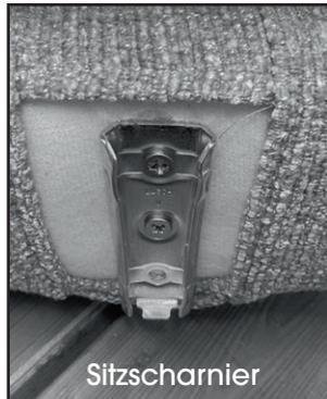
Positionieren Sie das Rücken-/Armteilscharnier genau über dem Sitzcharnier...
